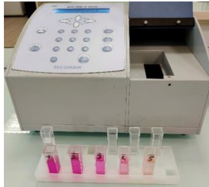
Spectrophotomètre et gamme de solutions étalons
