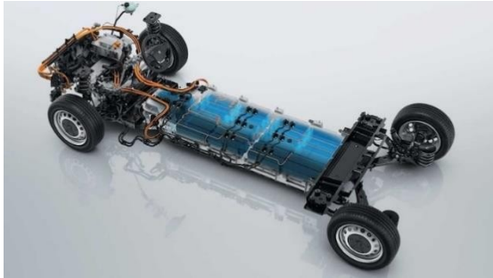
Pile à hydrogène intégrée au châssis d'une voiture
