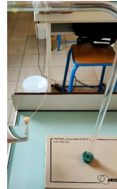
Attraction de la boule de sureau par la baguette « frottée »
